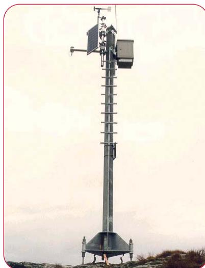
Située au sommet du Greppon Blanc, à 2714 mètres d'altitude celle-ci mesure les paramètres de direction du vent, de température de l'air et d'humidité relative de l'air. Elle est couplée aux stations de Combatseline, située à
